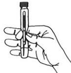
**SCHRITT 2.** Den unteren Teil des Behälters zusammendrücken und dabei farblose Ampulle zerbrechen, dann 10 Sekunden schütteln. Danach graue Ampulle (oben) zerbrechen und 60 Sekunden schütteln. (Wichtig: Erst farblose, dann graue Ampulle zerbrechen)
