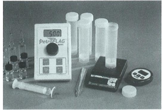
Beim PetroFLAG™ handelt es sich um einen neuen, portablen Schnelltest für Kohlenwasserstoff-Analysen von Bodenproben. Das System mit Extraktionslösungen, analytischen Reagenzien und dem batteriebetriebenen Messgerät zeigt mögliche Belastungen direkt in ppm (mg/kg) an. Der Detektionsbereich liegt zwischen 10 und 1000 ppm.
