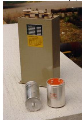
Abb. 2: PCB-haltige Kleinkondensatoren (auch aus Geräten)
