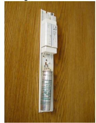
Abb. 3: PCB-haltige Vorschaltgeräte und Kondensatoren von Hersteller Knobel
