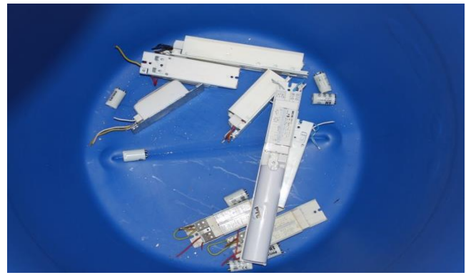
Abb. 4: PCB-haltige Vorschaltgeräte und Kondensatoren
