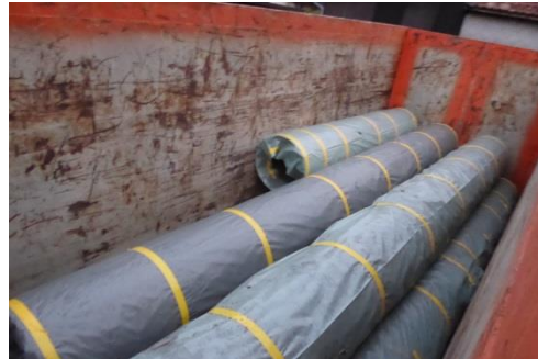
Abb. 4: PCB-beschichtete Druckrohre bereit für Transport
