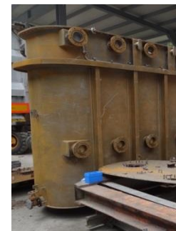
Abb. 3: Nach der Dekontamination im HDW-Verfahren
