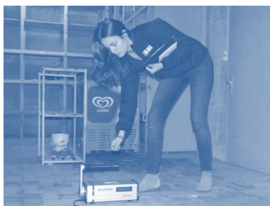
Bild 15: Radonmessung mit ETI-AlphaGuard (Quelle ETI)
