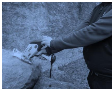
Bild 22: Feldanalyse Elemente mit Handmessgerät (Quelle ETI)
