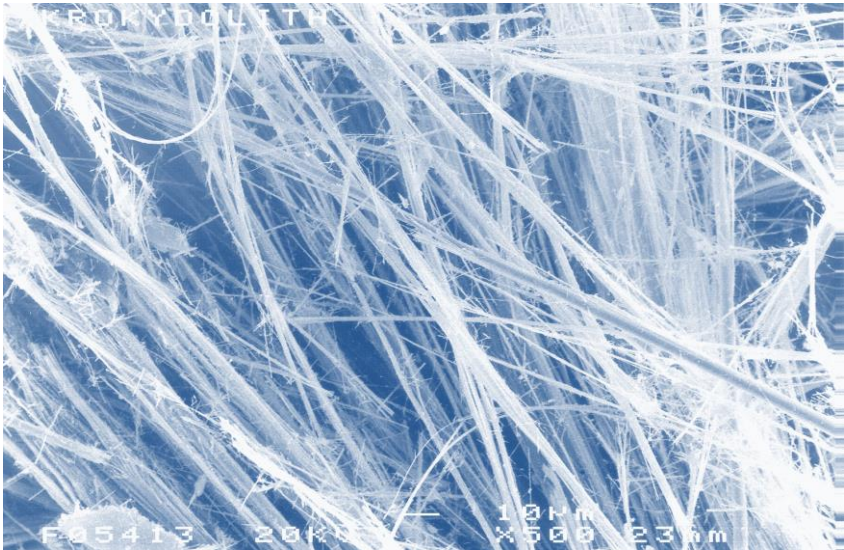
Bild 3: Blauasbest unter Rasterelektronenmikroskop (Quelle Aatest)
