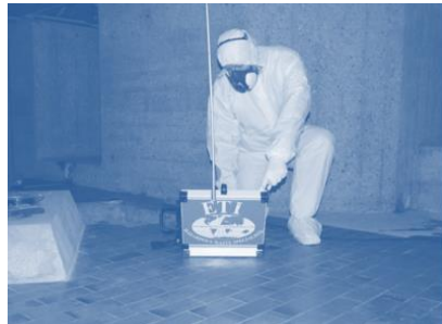
Bild 20: Zonenfreimessung (Quelle ETI)
